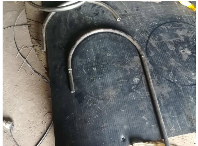
Fig. 4 Gabarit de cintrage rayon R=80 mm
